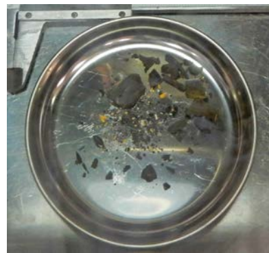
フード前養生シート上から 回収・集約した飛散物 (H29. 8. 2撮影)
