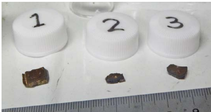
フード前養生シート上から回収した 飛散物の外観 (H29. 7. 20撮影)
