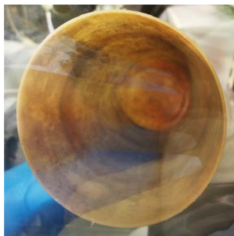
内容物回収後の容器内面の状態 (H29. 8. 3撮影)
